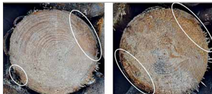
Abbildung 9 Beispiele für die Einordnung von Stammquerschnitten in Qualitätsklassen nach RVR [4]. Links: Stamm von B/C-Qualität mit zulässigen Fäulnisflecken am Rand des Querschnittes. Rechts: Stamm von D-Qualität mit beginnender Weichfäule
